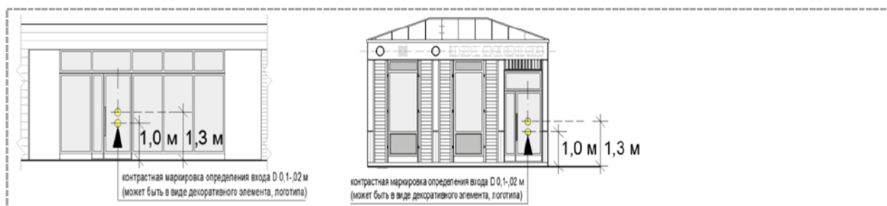
Рис. «Внешний вид контрастной маркировки входа»
